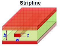
b : Dielectric layer thicknessw : Conductor widtht : Conductor thickness
